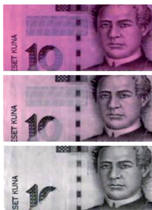
Slika 2: 570 nm Dobrila 10 kn, 715 nm Dobrila 10 kn, Z - 1000 nm Dobrila 10 kn [20]
