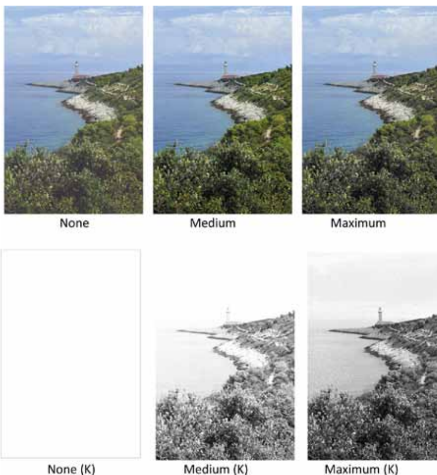
Slika 4. Prikaz slike konvertirane iz RGB u CMYK sustav putem GCR metode s tri načina generiranja crne (None, Medium, Maximum)
