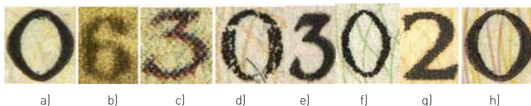
Slika 18 Izvorni knjigotisak a) i njegove imitacije: b) tintni писаč, c) laserski писаč, d) numerator, e) – g) sitotisak, h) knjigotisak
