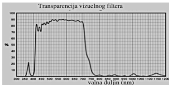
Slika 5. Primjer transparentnosti vizuelnog filtera (IR Cut Filter MF-CLD127S)
