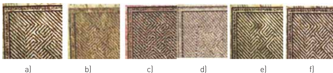
Slika 17 Izvorni intaglio tisak u vidu mikrotiska i latentne slike a) te njegove imitacije b) i c) tintni pisač, d) laserski pisač, e) i f) ofsetni tisak
